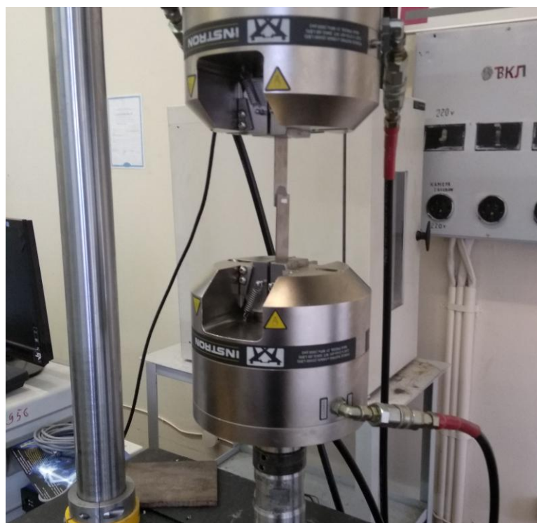
Рисунок 1.5 – Испытание клеевого соединения на растяжение при сдвиге
