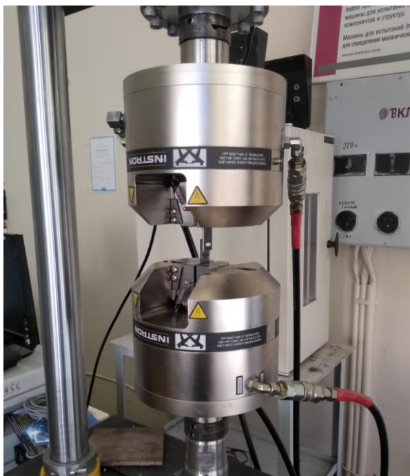
Рисунок 1.3 – Испытание клеевого соединения на растяжение при сдвиге
