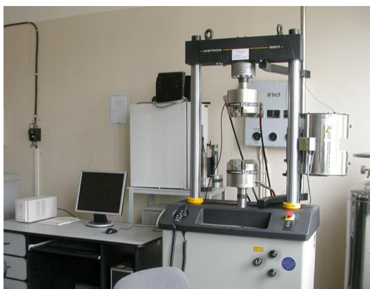
Рисунок 1.1 – Сервогидравлическая испытательная установка INSTRON 8801
