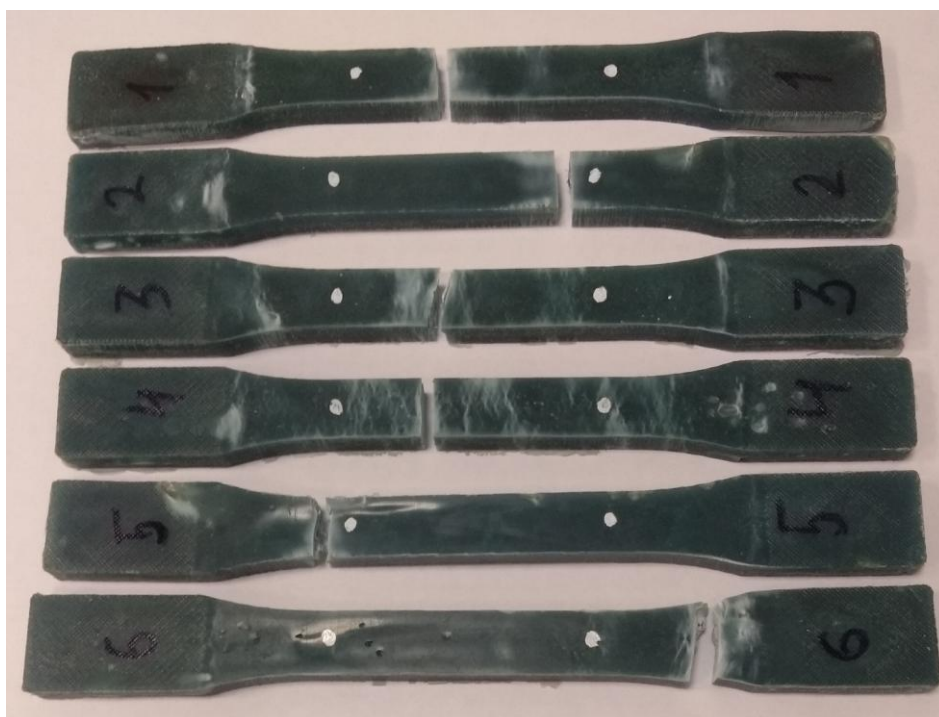
Рисунок 2.9 – Образцы, изготовленных из клея Plexus MA420 после испытаний на растяжение в соответствии с ASTM D638-14
