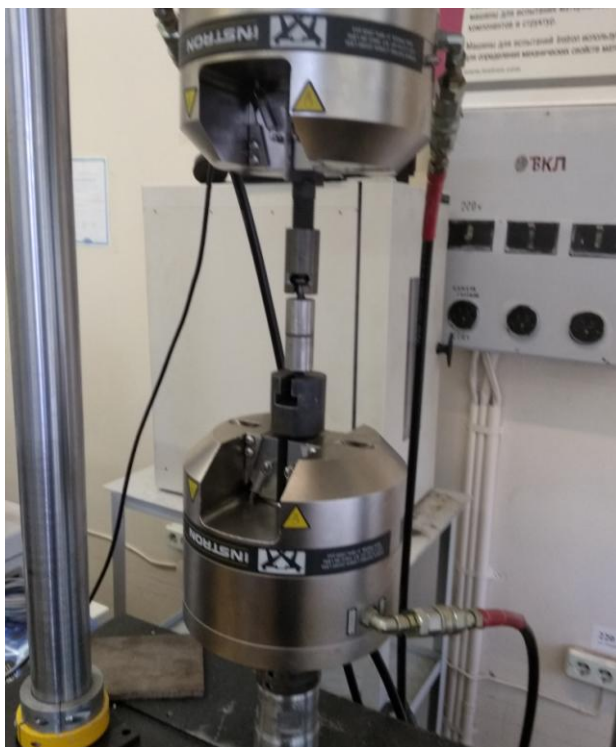
Рисунок 1.4 – Испытание клеевого соединения на растяжение с отрывом
