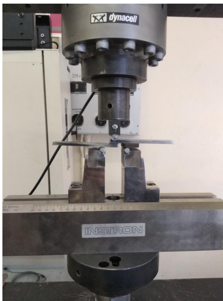
Рисунок 1.2 – Испытание клеевого соединения на изгиб со сдвигом
