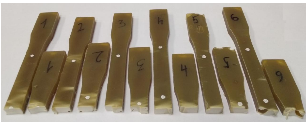
Рисунок 2.12 – Поверхности разрыва образцов, изготовленных из клея Acrid FS25
