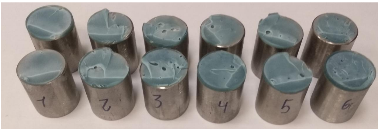
Рисунок 2.5 – Образцы, склеенные при помощи клея Plexus MA420 после испытаний на растяжение с отрывом в соответствии с ГОСТ 14760-69
