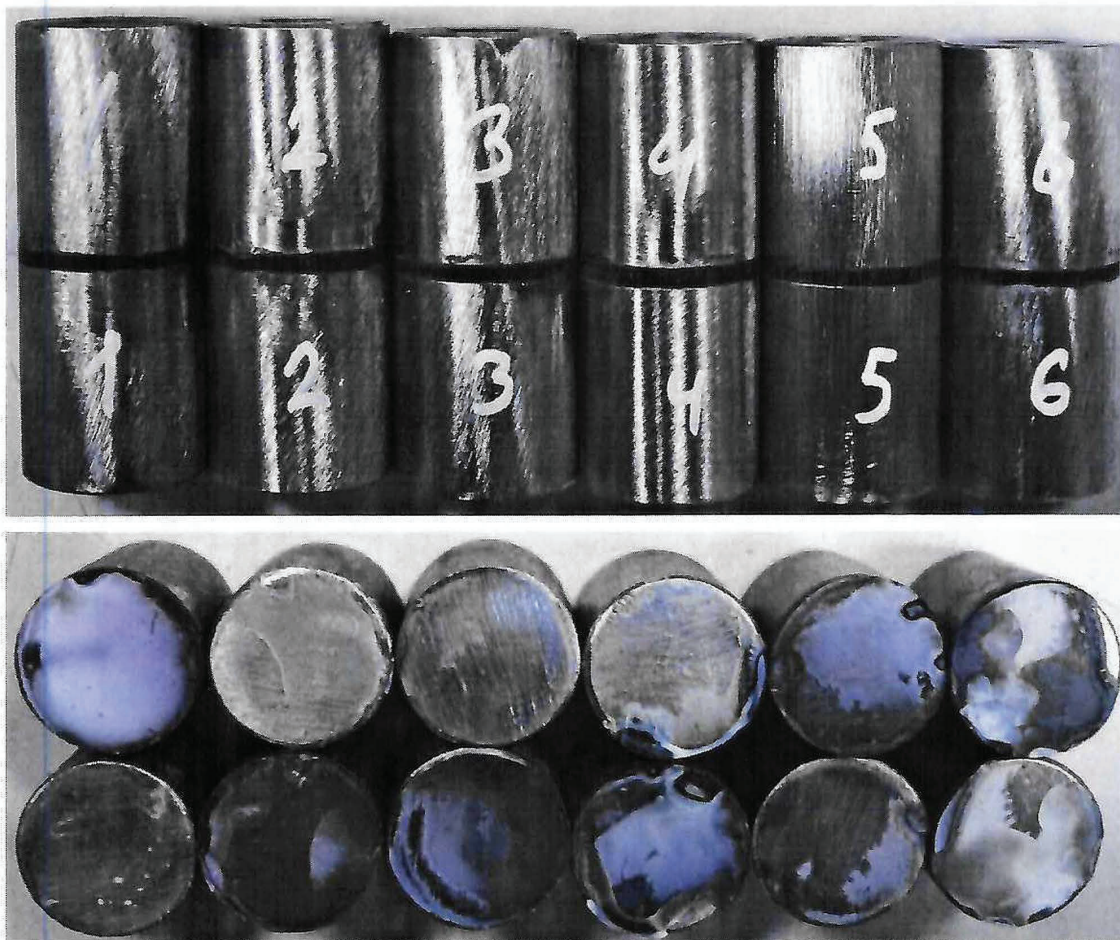
Фотографии образцов 1+6 до (сверху) и после (снизу) испытаний.
