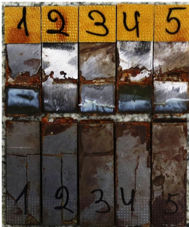
Фотографии образцов 1÷5 до (сверху) и после (снизу) испытаний.
