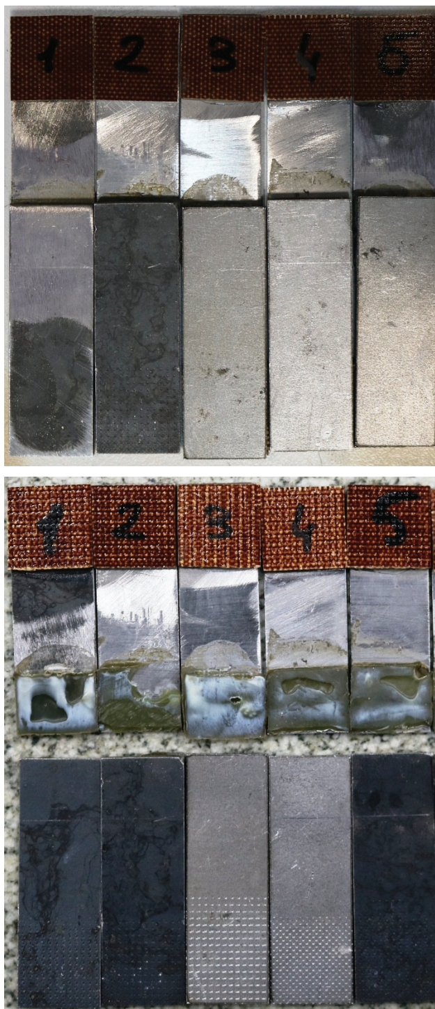
Фотографии образцов 1÷5 до (сверху) и после (снизу) испытаний.
